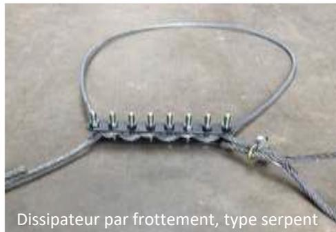
Dissipateur par frottement, type serpent
